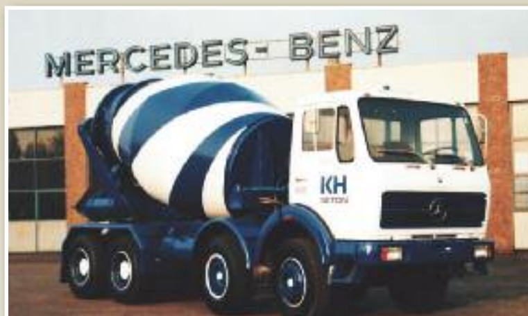
Den danskudviklede Mercedes L 2626 betonkanon til KH Beton havde en totalvægt på 31,5 ton. (Henrik Lange).
